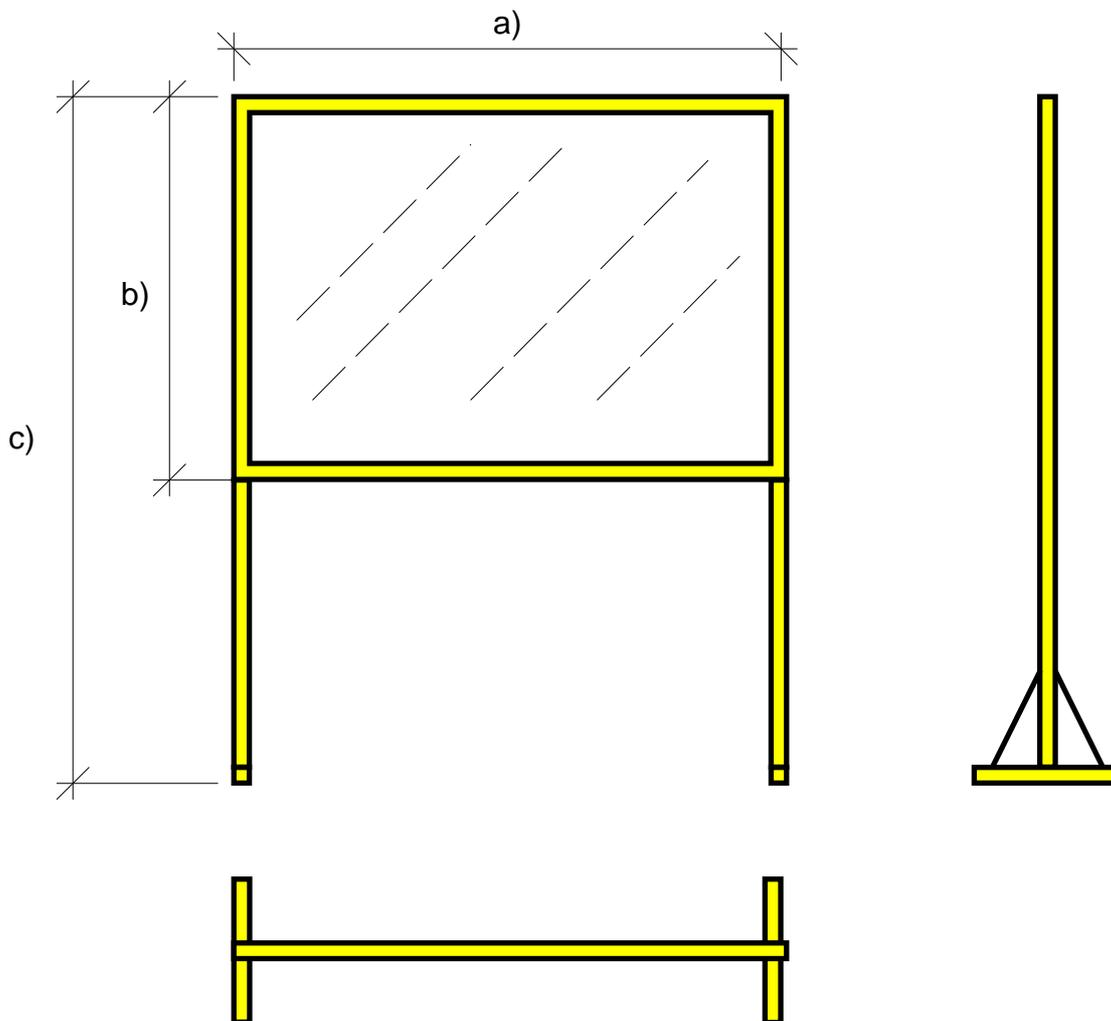
Protezione mobile contro la proiezione di schegge e trucioli in acciaio, con supporti a terra, dotata di pannellatura in materiale trasparente antiurto ( Art. 75 DPR 547/55 )
